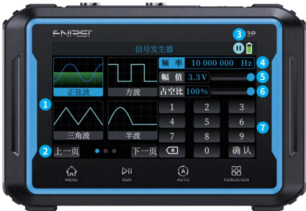
①**信号类型选择**:共有正弦波、矩形波、锯齿波、半波、全波、正阶梯波、反阶梯波、直流信号、指数升、指数降、多音频、辛克脉冲,12种波形。
