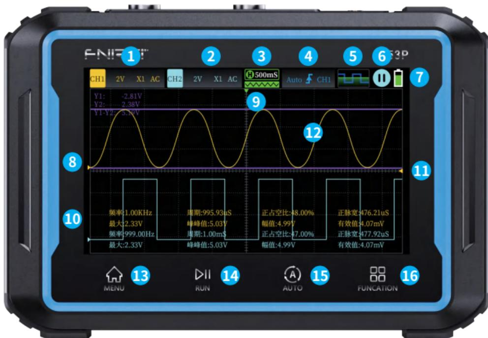
①**通道1设置**:可以设置通道开启/关闭、垂直电压、探头比例、耦合类型、20M带宽限制。
