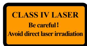
上面两个标识代表激光辐射,我们已将此标识贴在产品的激光器上盖靠近光纤输出口处。
