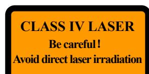
上面两个标识代表激光辐射,我们已将此标识贴在产品的激光器上盖靠近光纤输出口处。
